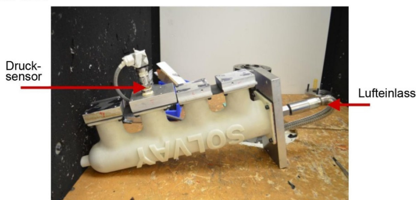
Berstdruckprüfung im Solvay-Technikum für Application Performance Testing (APT®): Die Resultate bestätigen eine Druckfestigkeit bis 3 bar ohne jede Rissbildung.
