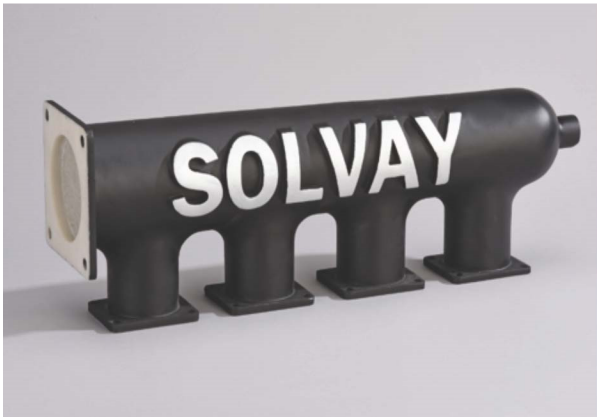
3D 프린팅을 통해 Sinterline® Technyl® 분말로 성형한 폴리모터 2 플레넘
